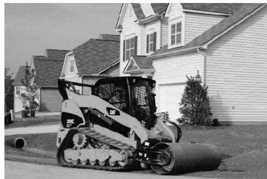
写真一十四 振動ドラム式コンパクタ
