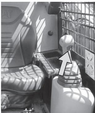
写真-2 2スピード切替トリガー
