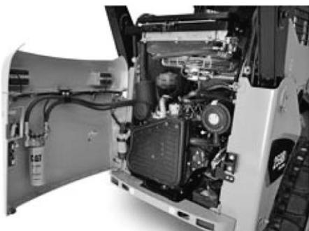
写真—7 チルトアップ式クリーニングシステム
