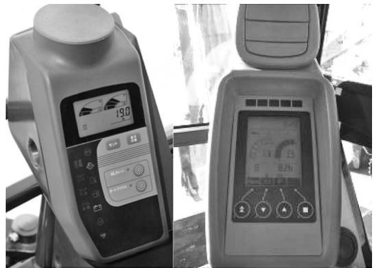
写真一8 左3型モニタ/右5型マルチモニタ
