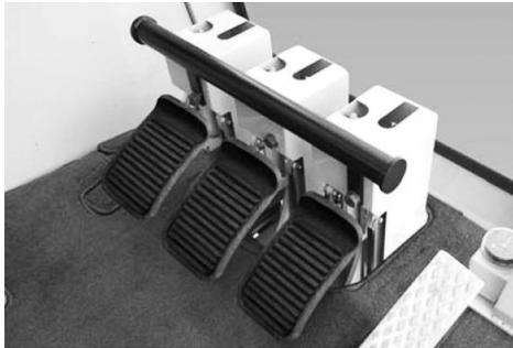
写真-2 つり下げ式ブレーキペダル
