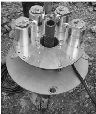
写真—1 計測システム（地上部）
