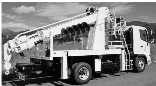
写真-5 アイチコーポレーション D70A ハイブリッド式穴掘建柱車
