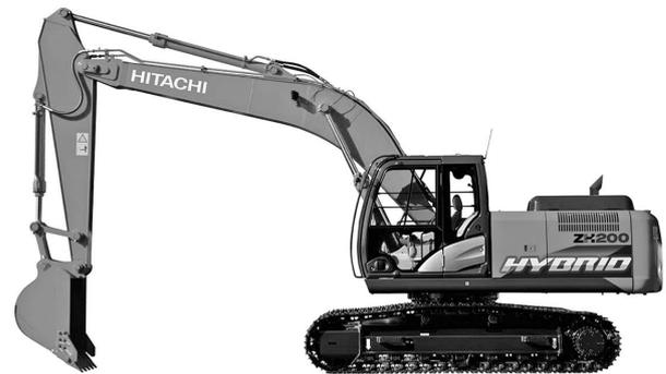
写真-2 日立建機 ZH200-5B ハイブリッド油圧ショベル
