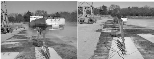
写真―5 試験状況（左：大型貨物車、右：乗用車）
