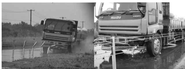
写真-3 実車衝突実験の状況 (板厚 4.2mm)
