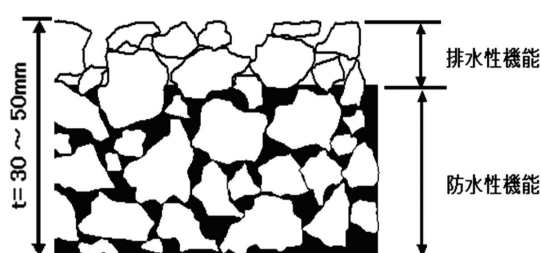
図一 多機能型排水性舗装の概念
