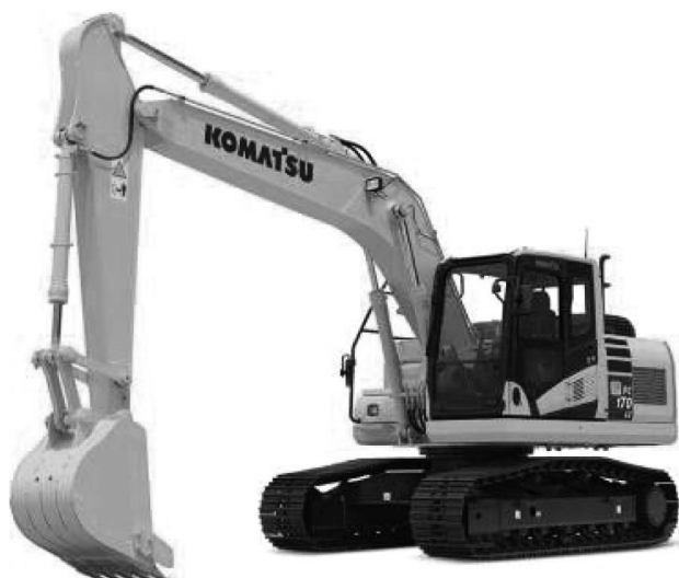
写真—2 コマツ PC170LC-10 油圧ショベル (一部オプションが含まれる)
