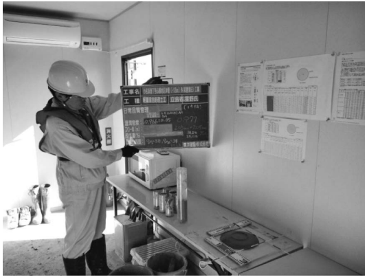
写真一 4 筒先での処理土の消泡率、およびフロー値の確認
