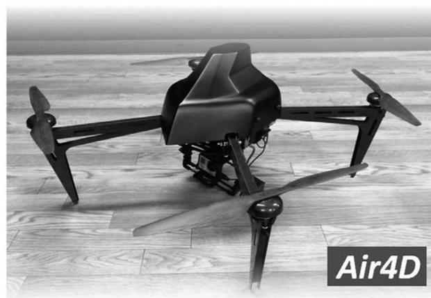
図一12 VTOLタイプのUAVの例
