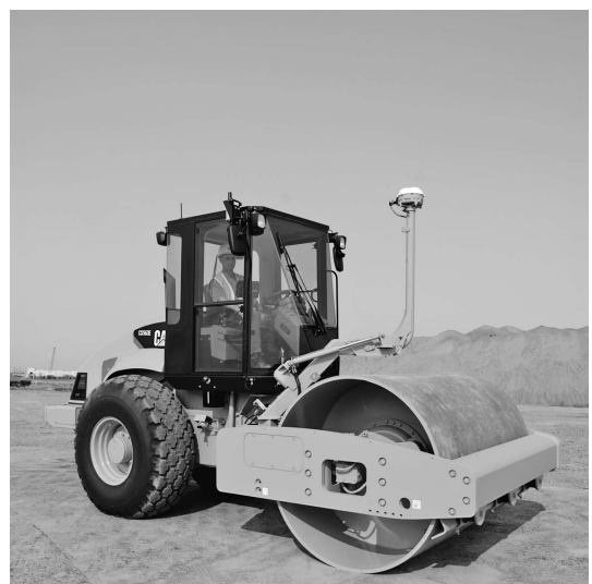
写真-3 海外のGNSS対応の振動ローラ
