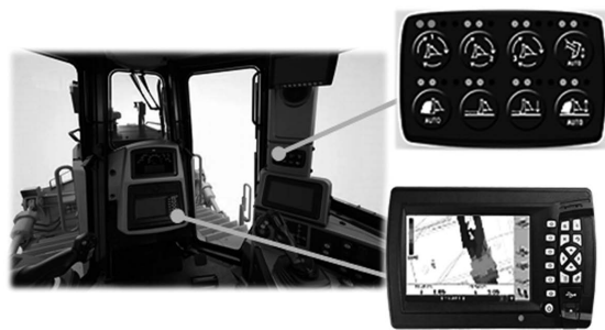
図-3 ブルドーザのオートマチックシステム操作パネル
