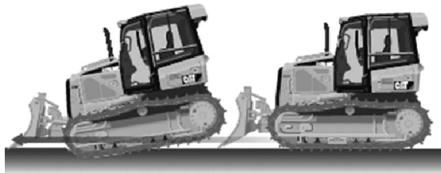
図-2 ステイブルブレードシステム模式図
