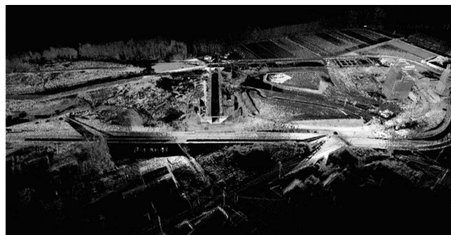
図—11 3Dスキャナによる測量点群データ
