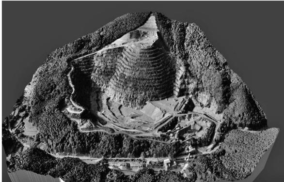
図一 17 3D モデルの Acrobat 出力例 (採石工事)
