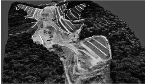
図一 16 3D モデルの Acrobat 出力例 (高速道路工事)<sup>3)</sup>
