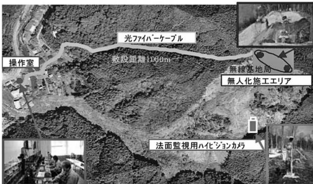
図-5 北股地区河道閉塞緊急対策工事仮設配置
