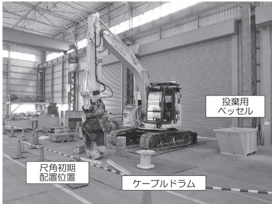
写真一八 性能評価実験設備配置
