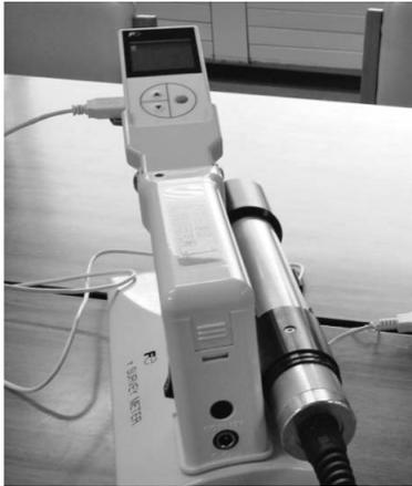
写真-1 放射線量測定器 (NaI シンチレーションサーベイメータ)
