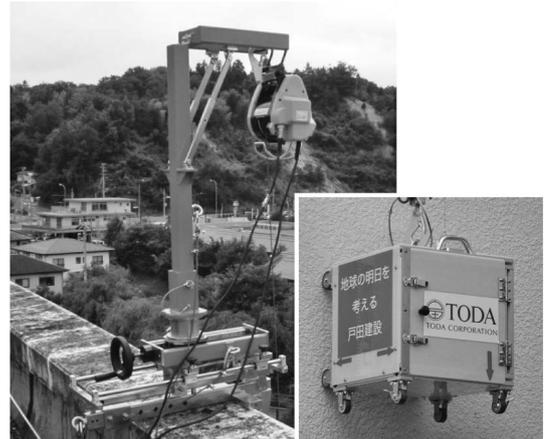
写真-2 放射線量測定装置 (左) 吊りアーム部と保持部 (右) 本体
