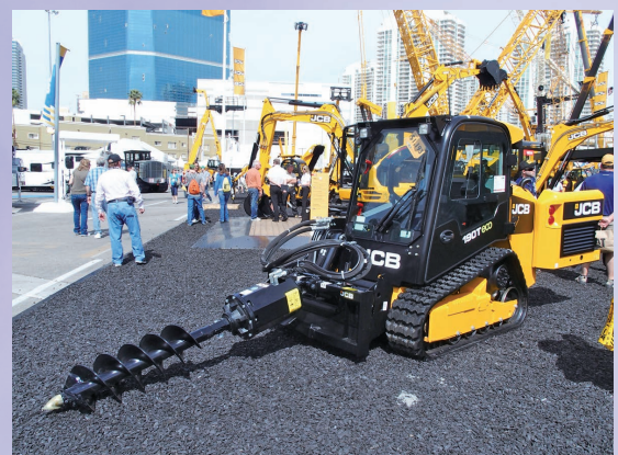
コンパクトトラックローダ 190T + ドリルアタッチメント
