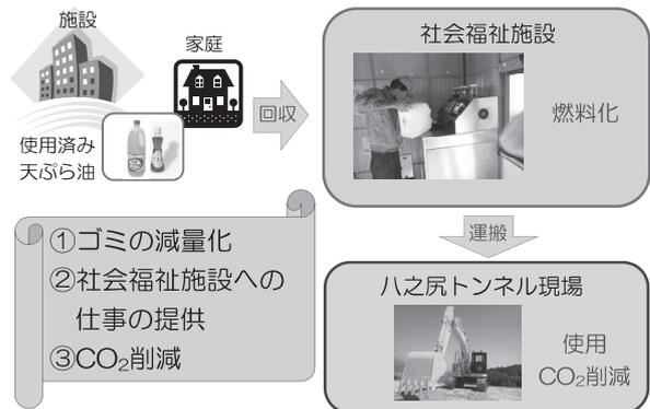
図—12 バイオディーゼル精製の流れ
