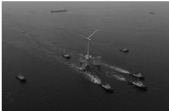
写真-6 2MW級洋上風力発電船の曳航状況
