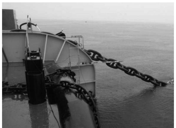
写真-5 引張試験の状況
