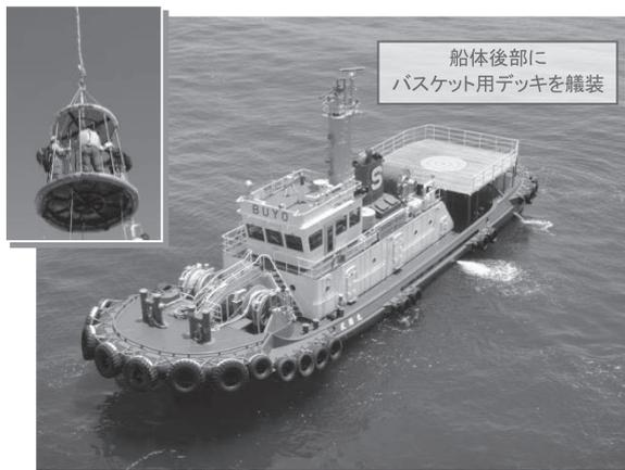
写真-9 専用アクセス船およびバスケット
