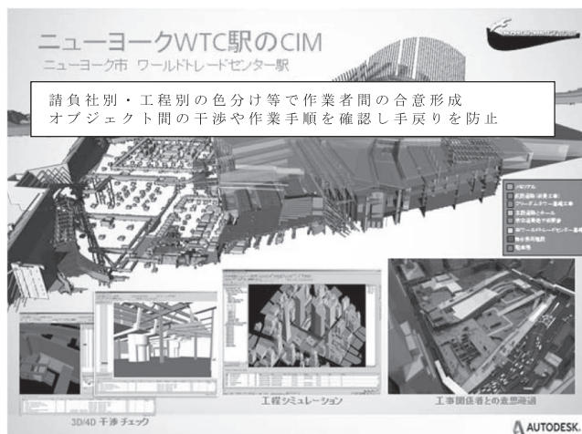
図は「米国におけるCIM技術調査2013報告書」より引用 図一 WTC 駅におけるCIMの適用状況
