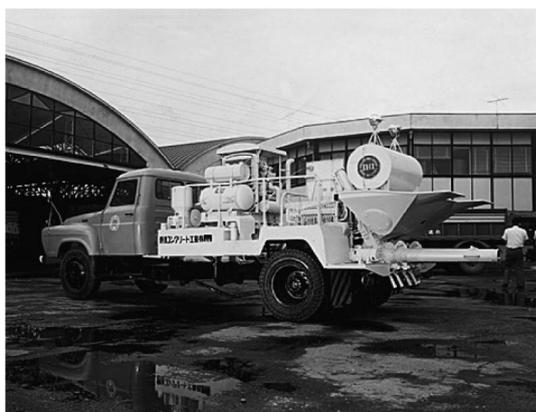
写真-4 PTB25TP型 (ダブルシリンダ式)
