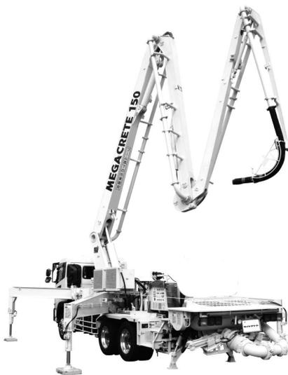
写真一12 超高圧コンクリートポンプ車 DC-SL1400BDH-M28
