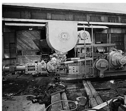
写真-1 機械式コンクリートポンプ 20A型
