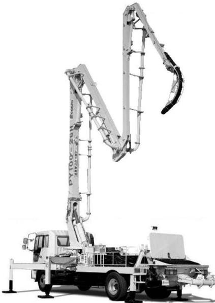
写真一11 高圧コンクリートポンプ車 PY100-26H
