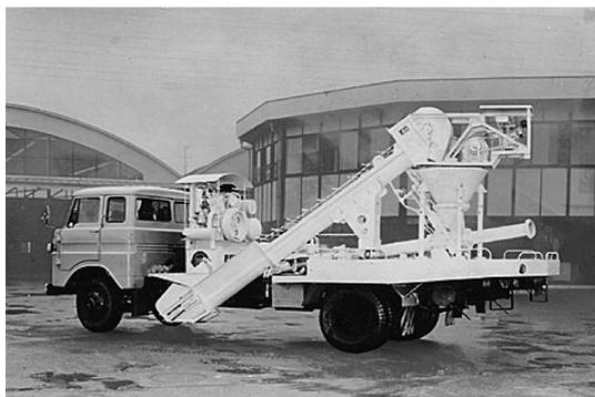
写真-3 トラック搭載式コンクリートポンプ PT12T型
