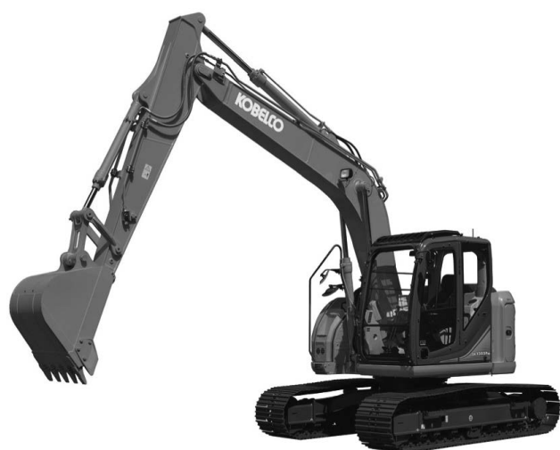
写真—3 コベルコ建機 SK135SR-3 油圧ショベル(後方超小旋回型)
