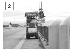
写真—10 移動時水平アーム先端部を補助員固定誘導
