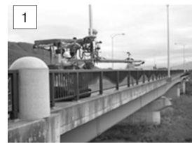
写真—10 移動時水平アーム先端部を補助員固定誘導
