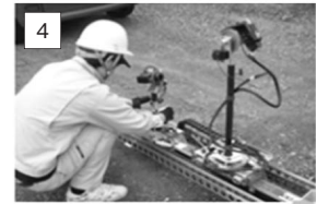
写真—8 カメラ台車・ケーブル取付け
