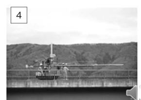
写真—11 点検位置への設置完了(現場到着から50分)
