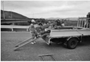
昇降スタンド立上げ状況 動力:インパクトレンチ又は手動
