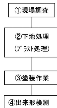
図—4 施工フローチャート
