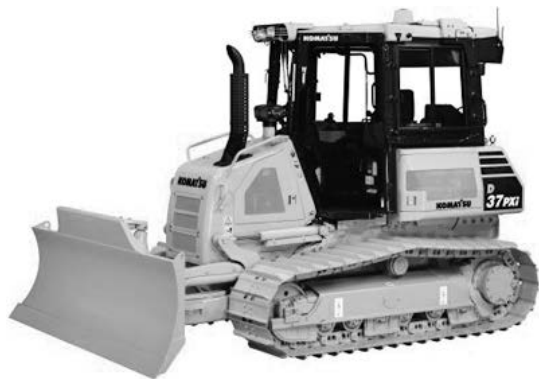
写真一 1 コマツ D37PXi-23 ブルドーザ （一部オプションが含まれる）
