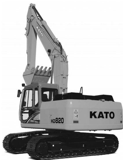
写真ー2 加藤製作所 HD820-6 油圧ショベル
