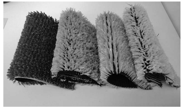
写真-3 袋材表面を人工芝構造として耐久性を高めたサンドバック
