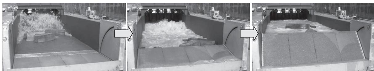
写真—3 流水(濁流)作動確認状況
