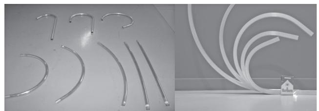
写真-2 三次元曲げ加工の一例
