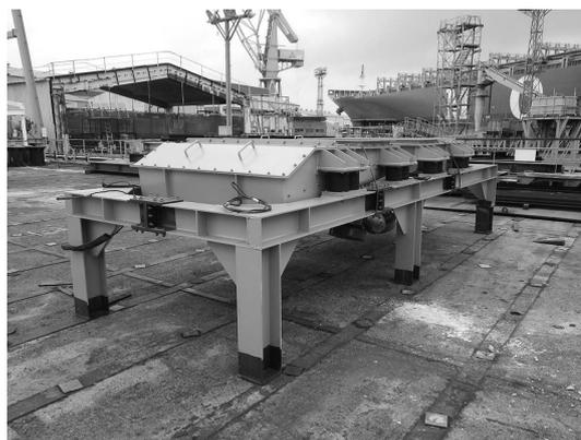
写真—2 搭載した振動フィーダー
