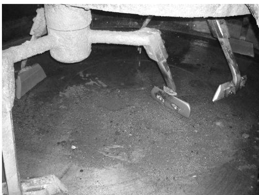
写真一七 ミキサー攪拌翼
