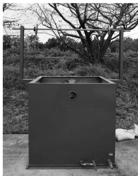
写真-3 固形対象物：鋼製立方体 (1,200 mm \times 1,200 mm \times 高さ 1,200 mm, 質量約 500 kg, 持ち手高さ 2,000 mm)
