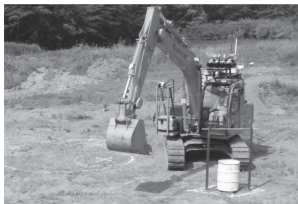
写真-5 モデルタスクⅡでの固形対象物の移設状況
