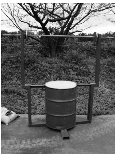
写真-1 固形対象物：ドラム缶 ( \phi 570 mm \times 高さ 760 mm, 質量約 100 kg, 持ち手高さ 2,000 mm)
