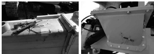
写真—6 ひずみゲージ取付状況
