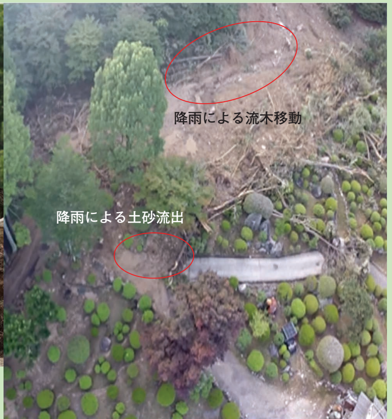
マルチコプターによる被災状況の空撮調査
