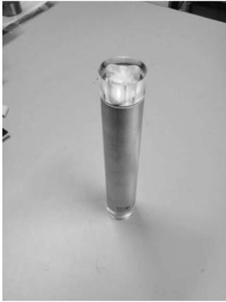
写真一七 ポケットに入るサイズの光る傾斜計
