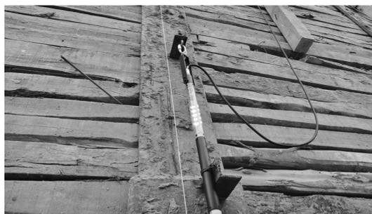
写真一 2 ニューデリーの開削現場で使用された光る変位計
