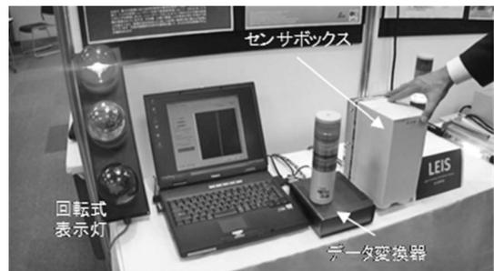
写真—5 加速度センサを使った光る傾斜計
