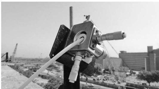
写真一八 ビルの屋上に設置したレーザーポインター
