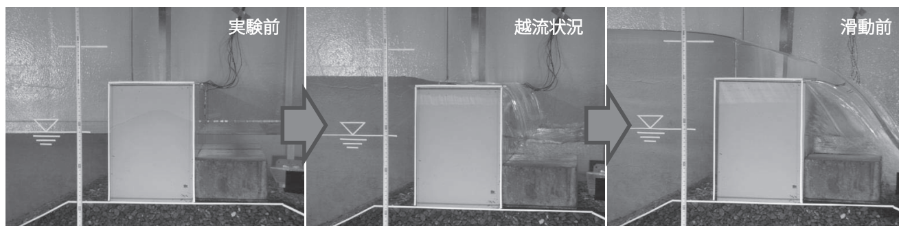
写真一七 実験状況 (No.5 アスファルトマット (あり/あり))
