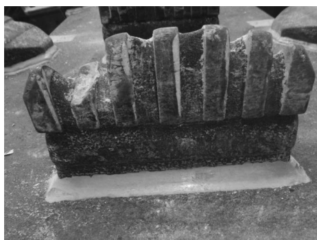
写真-5 強化先行ビット摩耗状況
