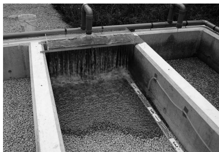
写真—2 模擬降雨排水実験の状況 (厚さ 20 cm, コンクリート床, 有孔管φ10 cm 布設)
