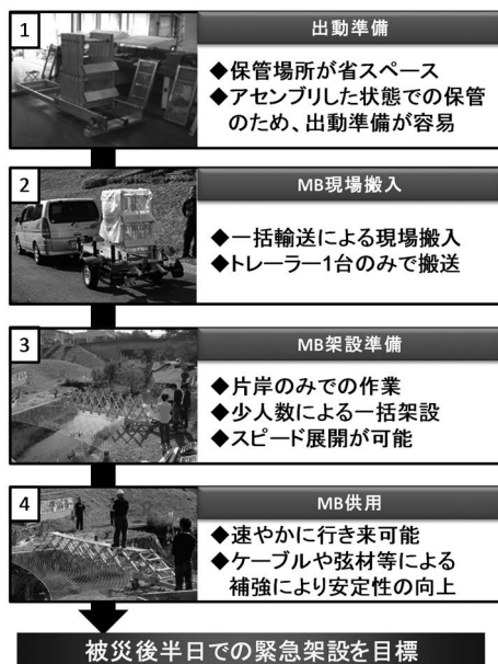
図-4 モバイルブリッジの出動フロー
