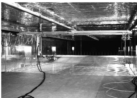
写真—3 温度成層風洞試験設備
