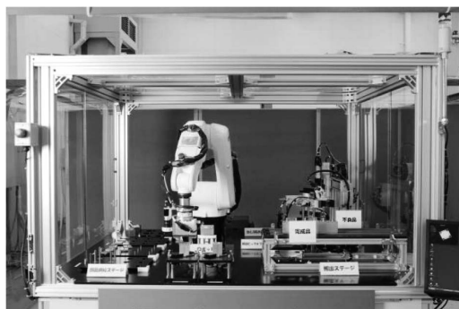
写真—5 精密組立ロボットシステム
