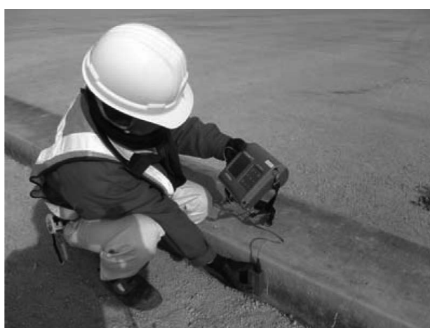
写真16 プロコメーターによる鉄筋かぶり測定
