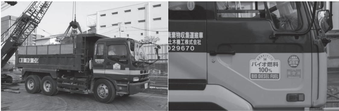
写真一六 B100 適用車両稼働状況
