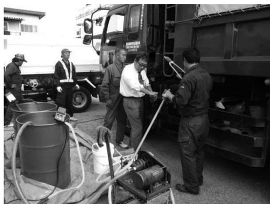
写真—5 B100 への燃料入れ替え状況
