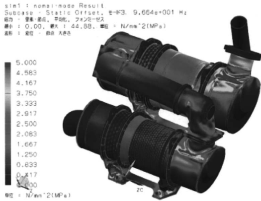
図一 19 後処理装置 FEM 固有値解析結果
