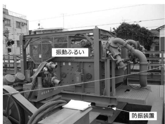
写真一6 防振装置設置完了
