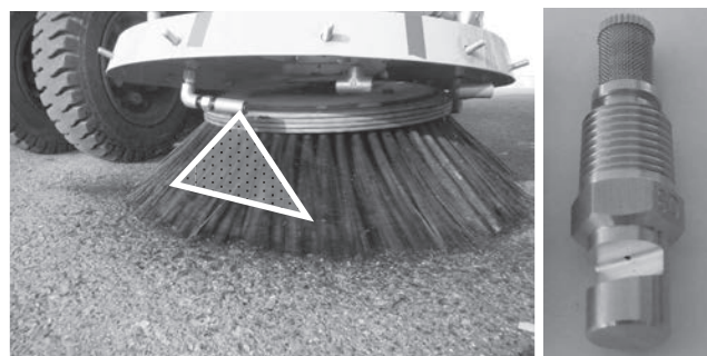
写真-3 散水の状況およびノズル（扇形，φ0.6）
