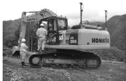
写真-1 情報化施工機器の設置状況(MGバックホウ)
