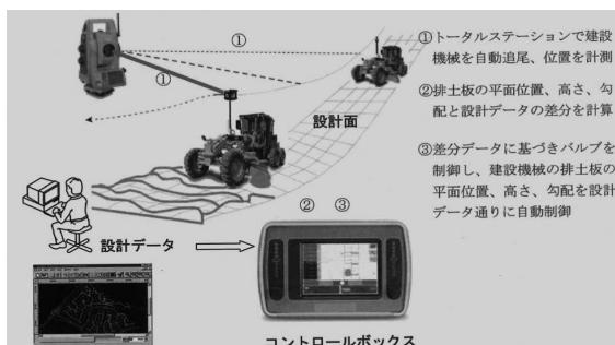
図-1 MC技術（例：MCモータグレーダ）の概要<sup>4)</sup>
