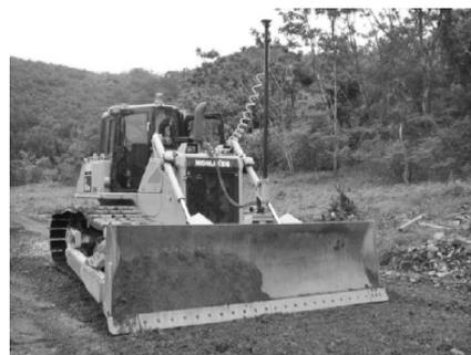
写真-2 情報化施工機器の設置状況(MCブルドーザ)
