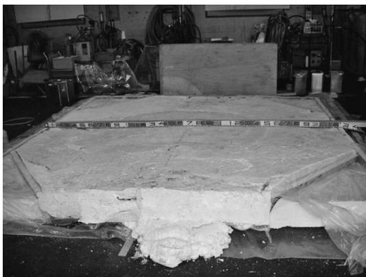
写真-5 流動性試験状況
