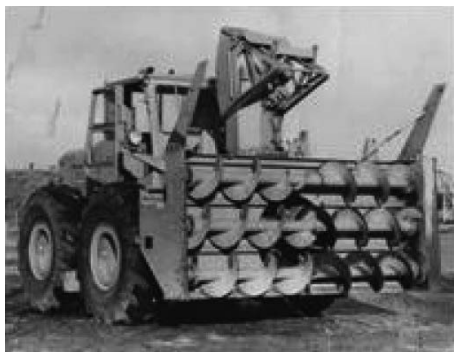
写真 2-10 三菱日本重工業(株) (注4) WHS 型ロータリ除雪車
