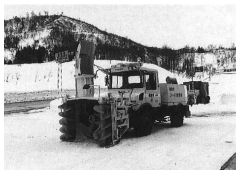
写真 2-19 立軸オーガ型、ツーステージ 450PS シュミット社（西ドイツ）TS—4 昭和 62 年 2)
