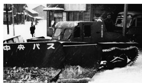
写真 2-7 旧陸軍戦車改造除雪車(写真 北海道中央バス)
