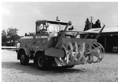
写真 2-21 (株)日本除雪機製作所 HTR-4 型 昭和 38 年
