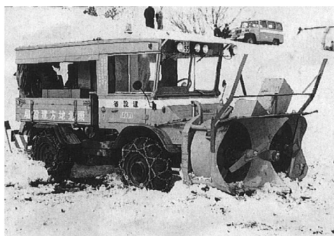
写真 2-16 ブロア型（2 ブロア）ワンステージ 走行動力 32PS、作業動力 110PS シュミット社（西ドイツ）昭和 38 年 2)
