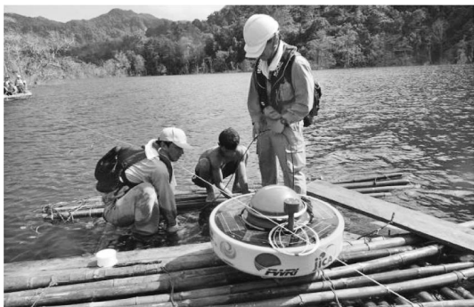
写真—4 水位観測ブイの設置状況
