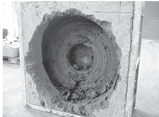
写真-9 掘進後の供試体 (前出し100 mm)
