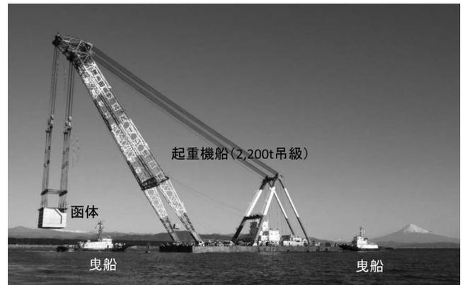
写真-5 起重機船による函体曳航
